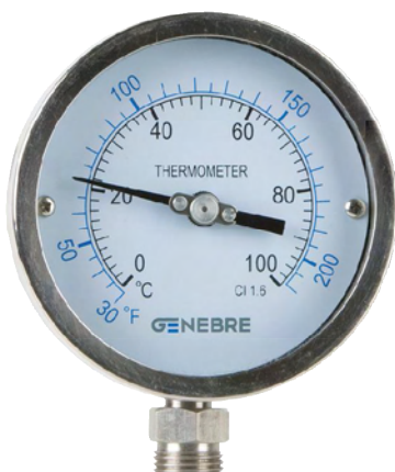
ART. 8037 Termómetros bimetalicos inoxidable 100 mm. inferior Material: AISI 304 Material vaina: AISI 316 Longitud vaina (L):100 mm.
