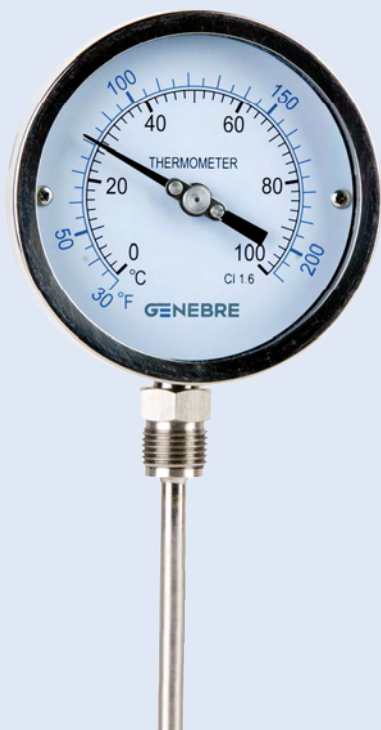
ART. 8040 Termómetro carga gas conexión local L=100 Elemento de medida: gas inerte Longitud vaina 100 mm. AISI 316
