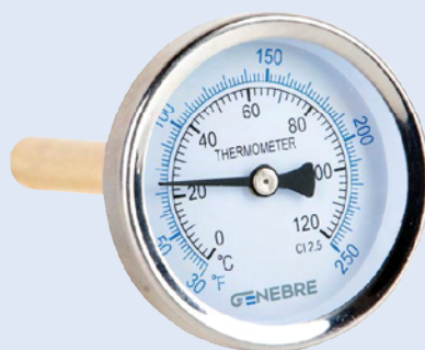
ART. 8032 (posterior) 8033 (inferior) Termómetros bimetálicos 63 mm. Material de la vaina: Latón Diámetro de la vaina: 8 mm.
